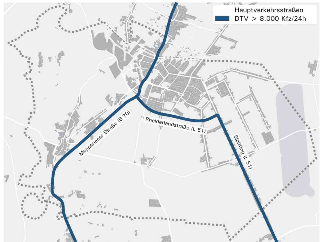
Abb. 1 Verkehrswichtige Straßen mit einer DTV > 8.000 Kfz/24h
